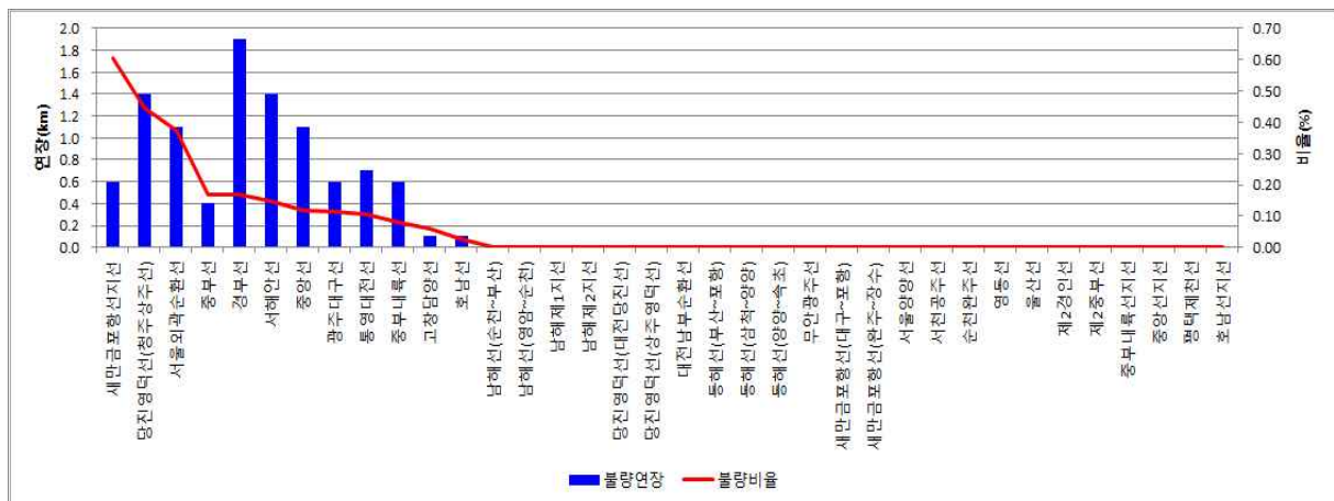
그림 4.10 노선별 시멘트콘크리트포장 불량비율 및 연장
